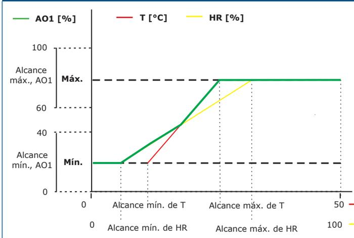
**NOTA:** La salida cambia automáticamente, dependiendo de los valores más altos de T y HR, es decir, el más alto de los dos valores de salida efectuará su control. Véase la línea verde del 'Diagrama de funcionamiento'. Se pueden desactivar una o varias mediciones. Por ejemplo, es posible controlar la salida solamente en función de las mediciones de temperatura.
