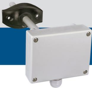
Las series DSMFM-2R incluyen transmisores multifuncionales para conductos, que miden temperatura, humedad relativa y nivel de concentración de CO<sub>2</sub>. Sobre la base de las mediciones de temperatura (T) y humedad relativa (HR), se calcula el punto de rocío. Estos dispositivos se alimentan a través de 'Power over Modbus' y todos sus parámetros son accesibles también por medio de dicha comunicación.
