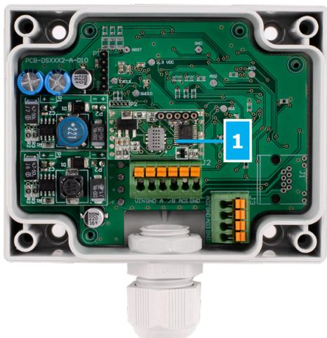
1 - Elemento sensor de CO / NO<sub>2</sub> reemplazable Reemplazable en caso de defecto
