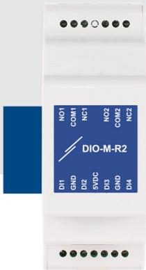
El DIO-M-R2 es un módulo de entrada/salida (I/O) para redes Modbus RTU, que tiene 4 entradas digitales, 2 salidas de relé y comunicación Modbus RTU. Este módulo posibilita la conexión y el control de dispositivos sin comunicación Modbus RTU a una red Modbus RTU.
