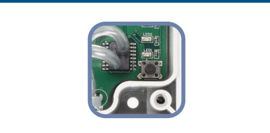
**Fig. 9 Calibration & Modbus reset indication**
