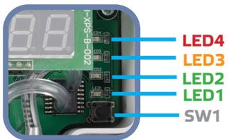
**Fig. 6 Calibration & Modbus reset indication**
