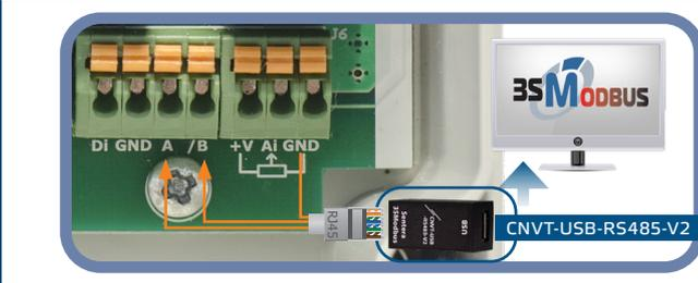
**Fig. 5 3SModbus RJ45 Anschluss**
