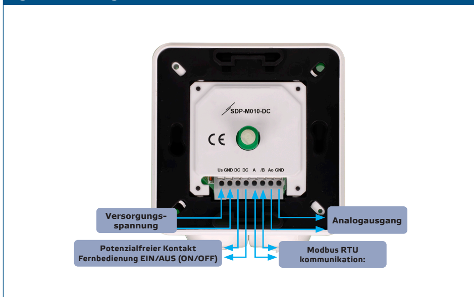
Fig. 1 Verkabelung und Anschlüsse
