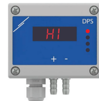
Fig. 12 b Oberhalb der Höchstgrenze des Regelbereichs
