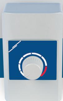
Der USV-8/010-PA ist ein aktiver Potentiometer (Versorgungsspannung 85–264 VAC / 50–60 Hz) mit 0–10 VDC / 0–20 mA / PWM Ausgang und wurde entwickelt zur Regelung von EC Ventilatoren / Motoren oder anderen Geräten die ein 0–10 VDC / 0–20 mA / PWM Eingangssignal brauchen.
