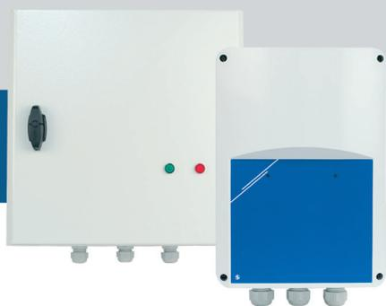
Die Transformatorregler STVS regeln die Drehzahl von einphasigen, spannungssteuerbaren Motoren in fünf Stufen, indem sie die Ausgangsspannung entsprechend einem analogen Eingangssignal von 0–10 VDC variieren. Sie sind ausgestattet mit Autotransformator(en) und verfügen über TK Überwachung für thermischen Motorschutz. Bis 7,5 A sind die Regler erhältlich in einem Plastikgehäuse, über 7,5 A in einem Metallgehäuse
