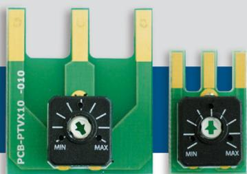
PTV Trimpotentiometer bieten eine manuelle Steuerung der Drehzahl von spannungssteuerbaren einphasen (230 VAC, 50–60 Hz) Motoren und bieten ein 0–10 VDC Direktsteuersignal. Es gibt zwei Produktversionen: PTV-X05.5 Montage zu einer Standardklemme, Pitch 5 mm und PTV-X10.0 Montage zu einer Standardklemme, Pitch 10 mm.
