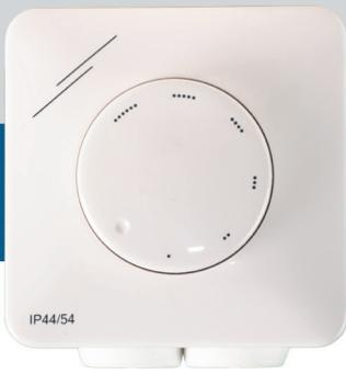
Die MT Drehzahlsteller ermöglichen die manuelle Drehzahlregelung von spannungssteuerbaren (230 VAC / 50 Hz) Motoren durch Änderung der Versorgungsspannung mittels Phasenanschnittsteuerung. Sie sind geeignet für Auputz- und Unterputzmontage. Mehreren Lüftern können angeschlossen werden, solange die Stromgrenze nicht überschritten wird. Alle Modelle verfügen über einen zusätzlichen (ungeregelten) 230 VAC Ausgang.
