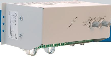
Die elektrischen Proportional-Heizungsregler EH3C sind für die Regelung der Lufttemperatur in dreiphasigen (400 V) Heizungssystemen ausgelegt, indem sie eine stufenlos einstellbare Regelung der Last bieten. Der Regler regelt das Verhältnis zwischen On-Time und Off-Time, um die benötigte Heizleistung zu erzeugen.
