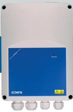
ECMF8-DM ist ein Drehzahlregler mit Modbus RTU Kommunikation, zwei analogen/modulierenden/digitalen Eingängen, zwei Tachoeingängen und zwei analogen/modulierenden Ausgängen zum Anschluss von EC Ventilatoren oder einem Frequenzumrichter. Das Gerät kann für die Steuerung von 1 oder 2 Ventilatoren nach einer oder mehreren Sensormessungen oder nach herunterladbarer anwendungsspezifischer Firmware (Lösungen) wie Destratifizierung in Lagerhallen, Luftschleiersteuerung usw. verwendet werden.
