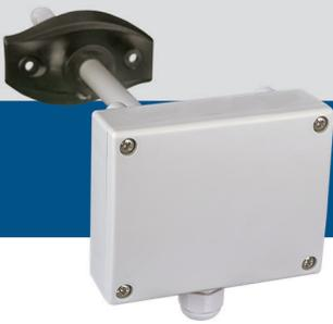
Die Produktreihe DSVCX-R sind multifunktionale Transmitter für Kanaleinbau die Temperatur, relative Feuchte und eine breite Palette an flüchtigen organischen Verbindungen (TVOC = total volatile organic compounds) messen. Die TVOC-Konzentration ist ein genauer Indikator für die Innenluftqualität. Die Serie verfügt über 3 analoge / modulierende Ausgänge - einen für Temperatur, einen für relative Feuchte und einen für TVOC. Alle Parameter und Messungen sind erreichbar über Modbus RTU.
