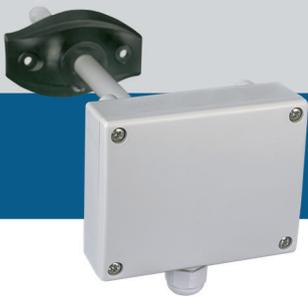
Die Produktreihe DSMFM-2R sind multifunktionale Kanaltransmitter die Temperatur, relative Feuchte und die CO<sub>2</sub> Konzentration messen. Basierend auf den Messungen der Temperatur und relativen Luftfeuchtigkeit wird die Taupunkttemperatur berechnet. Sie werden über Modbus versorgt. Alle Parameter sind erreichbar über Modbus RTU.
