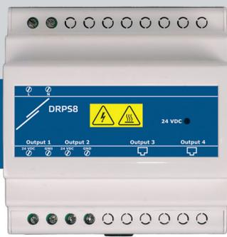
Der DRPS8-24/40 ist ein 24 VDC / 40 W Stromversorgungsmodul für DIN-Schienenmontage mit zwei RJ45 Buchsen und Klemmleisten für Anschluss der Ausgangsspannung. Sie sind kompatibel mit Power über Modbus und haben einen breiten Spannungsversorgungsbereich.
