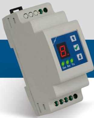
DRE, ein digitaler Motordrehzahlregler mit einem geregelten Ausgang und unregulierten Ausgabe, minimale und maximale Ausgangsspannung Einstellung und Kick-Start / Soft-Start-Auswahl. Alle Parameter lassen sich über eine 3-Tasten-Schnittstelle mit 7-Segment-Anzeige implementieren oder über eine benutzerfreundliche Software-Anwendung für Windows (3SModbus), Modbus RTU (RS485) Kommunikation.
