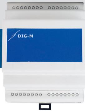
Das Internet-Gateway DIG-M-2 ist ein Gerät, das dazu dient, Sentera-Geräte an das Internet anzuschließen, um sie über SenteraWeb zu überwachen und zu konfigurieren. Das Gerät verfügt über 2 Modbus RTU-Kanäle - einen Slave-Kanal, an dem die Sentera-Geräte angeschlossen sind, und einen Master-Kanal zum Anschluss einer Master-Steuerung oder eines GLT. Es kann über Ethernet oder Wi-Fi an das Internet angeschlossen werden.
