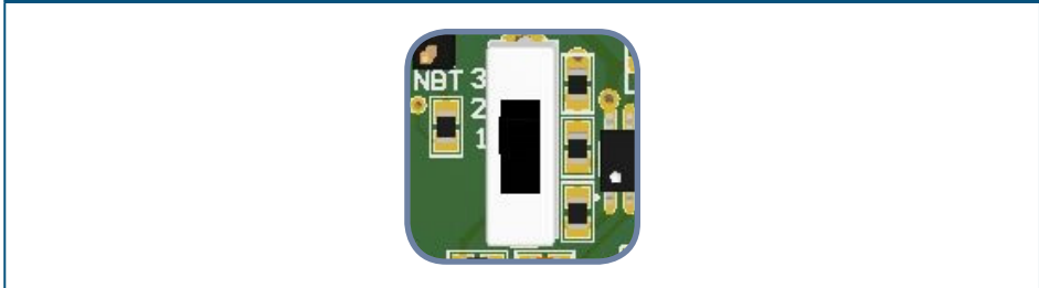
Fig. 5 Превключвател за избор на аналогов изход (SW1)
