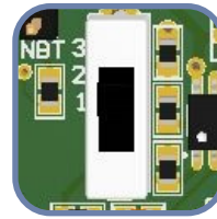
Фиг. 5 Джъмпер за избор на режим на работа на аналоговия изход
