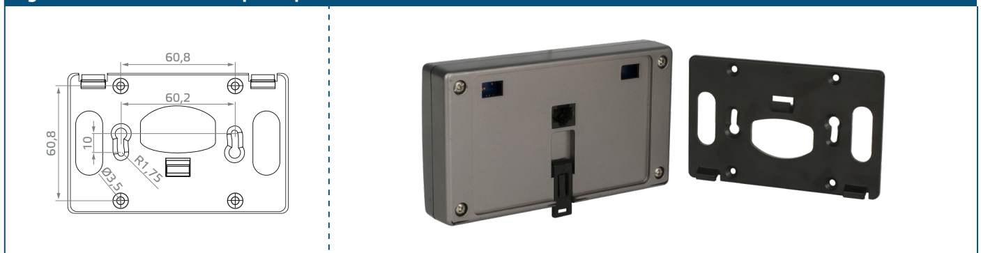
Fig. 2 Монтаж и монтажни размери
