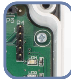
Фиг. 10 Джъмпер за нулиране на Modbus регистрите за съхранение
