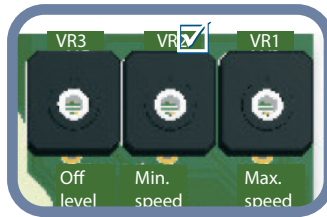
Фиг. 7 Тример за настройка на мин. обороти
