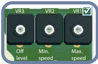
Фиг. 6 Тример за настройка на макс. обороти
