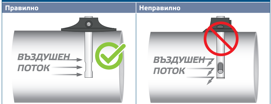
Фиг. 2 Положение за монтаж
