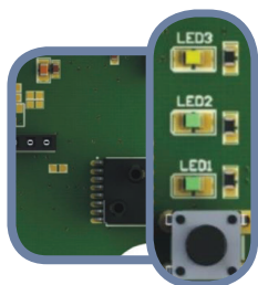
Фиг. 7 Бутон за стартиране на процедури за калибриране на датчика и възстановяване на фабричните Modbus настройки
