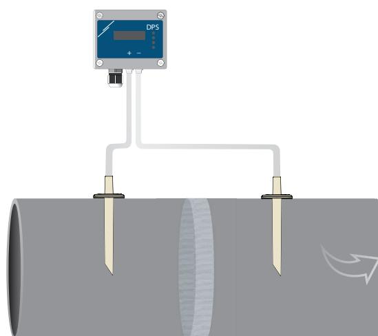
**Приложение 2:** Измерване на обем на въздушния поток [m<sup>3</sup> / h] с помощта на тръба на Пито PSET-PT
